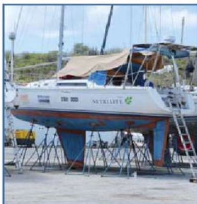
Al Curaçau Marine le barche vengono posizionate su cavalletti in acciaio e assicurate a quattro bitte del piazzale.
