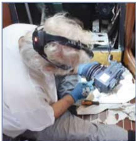
Tra i lavori su Obiwan non è mancato il check-up completo all'entrobor- do, con sostituzione di cinghie e filtri.
